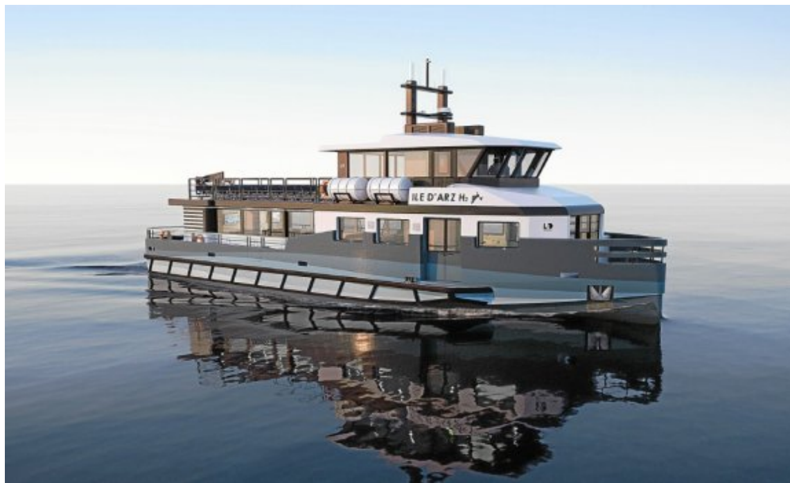
Le projet Hylas, un projet de navire de 150 à 200 passagers, long de 24 m, à propulsion hydrogène électrique, pour desservir l'île d'Arz dans le Golfe du Morbihan à l'horizon 2024. (Photo L20Naval)
